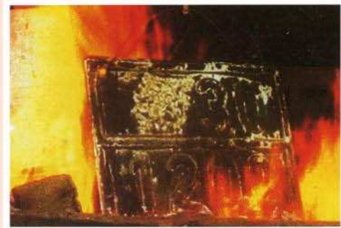
Huidige ADR na 30 minuten brand Panneau actuel après 30 minutes d'incendie
